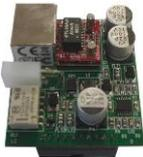
Modulo per la programmazione e la gestione dei dati utilizzando la rete LAN disponibile sull'impianto.
